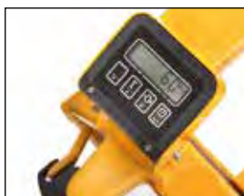
Handpallettruck met weegschaal
