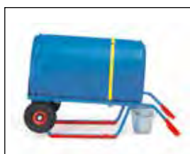
Steekwagen ingebruik bij aftappen.
